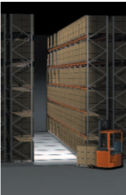
Energibesparing - om erforderlig belysning kan kopplas till den öppna gången minskar man energikostnader.
