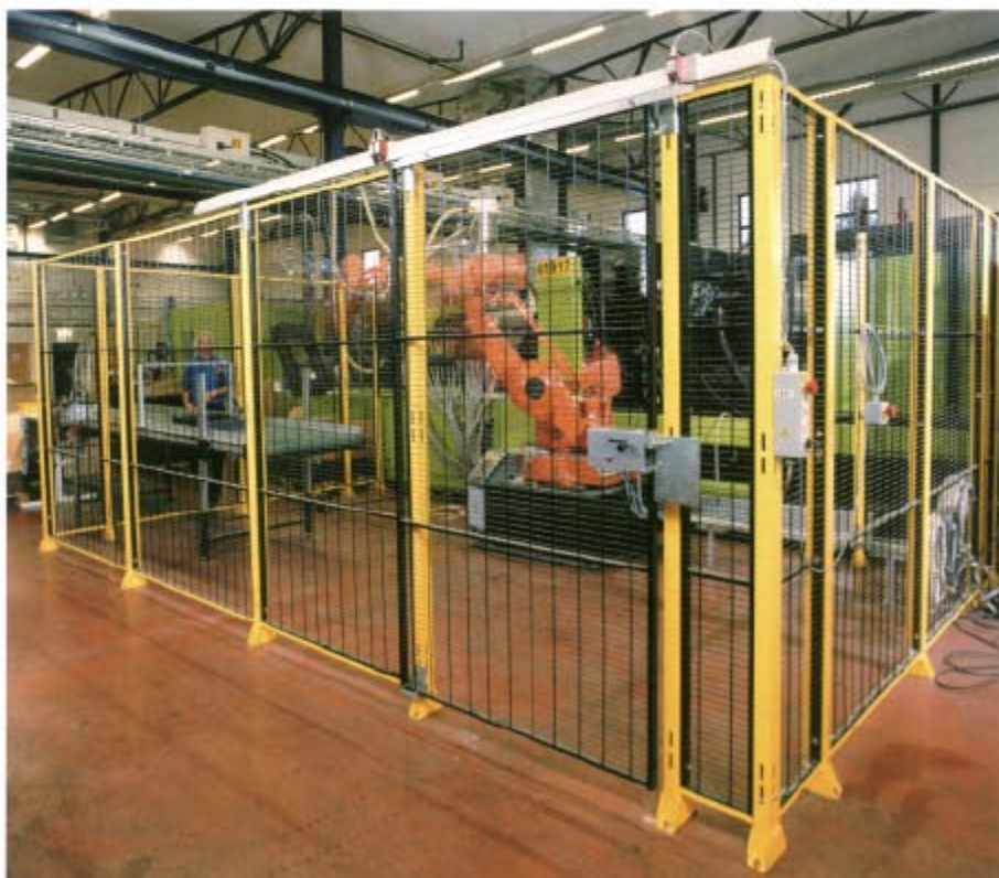
MasterGuard runt en plastmaskin på Plastunion i Anderstorp.
