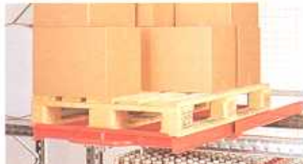
Utdragsenhet underlättar plockning av detaljer från pall.
