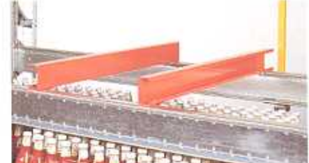
Gaffeldistanser för lagring av plattor, kartonger, etc när lastpall ej används.
