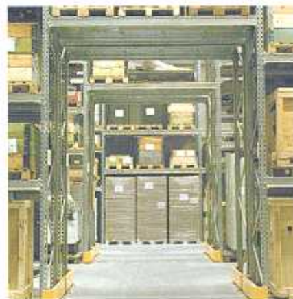
Tunnel: ett sätt att utnyttja lagerutrymmet maximalt.
