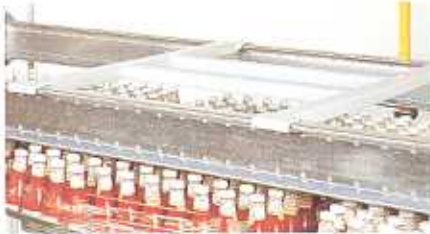
Insats för halvpall. Gör det möjligt att lagra halvpallar i stället.
